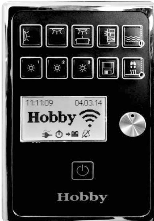
Das Hobby CI-BUS-Bordmanagement kann bis zu 15 Geräte miteinander vernetzen, um diese über ein zentrales Panel bedienen zu können und deren Funktionen über ein Display anzuzeigen. **(Standard).**
