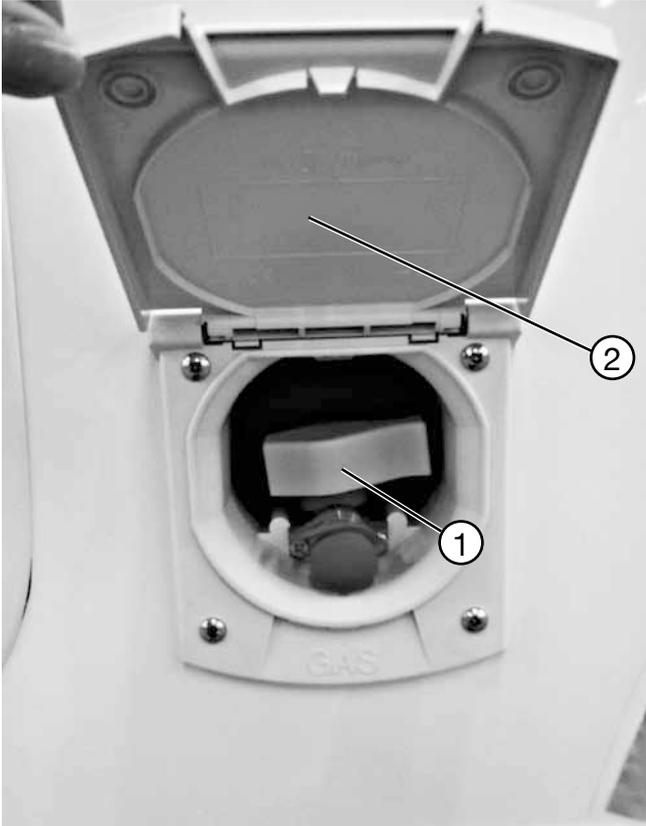
Die Gasaußensteckdose kann für den Anschluss von Gasgeräten (z.B. Grill) verwendet werden.
