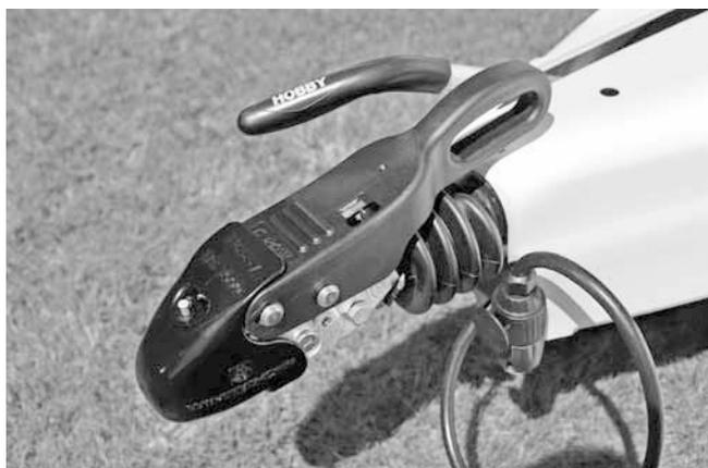
Der Caravan ist mit einer Sicherheitskupplung inklusive Spurstabilisierung ausgerüstet, mit der Schlinger- und Nickbewegungen des Anhängers unterdrückt werden. Dieses System entspricht der ISO 11555-1 und ist für die Verwendung bis zu einer Höchstgeschwindigkeit von 100 km/h zugelassen.
