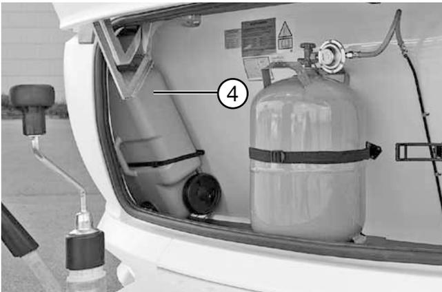
Während der Reise kann der Abwassertank ④ platzsparend im Gaskasten untergebracht werden. **Ausnahme:** Beim Landhaus wird der Abwassertank unter dem F-Bett verstaut. (zugänglich über die Serviceklappe)
