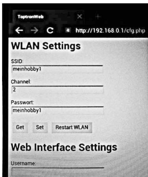
Hier können der Name des Netzwerkes sowie das Passwort geändert werden. Dies gilt auch für die Web Interface Settings. Die UMTS und NOIP Settings werden derzeit noch nicht unterstützt und sind nur für zukünftige Anwendungen integriert.
