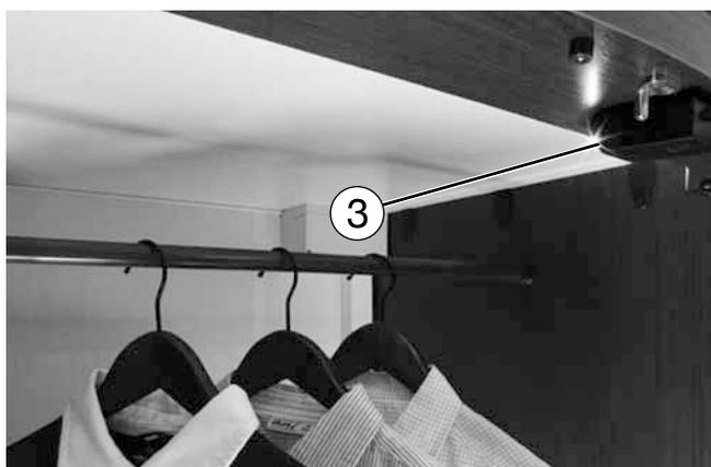
Die Kleiderschrankbeleuchtung ③ wird durch das Öffnen der Kleiderschranktüren über einen integrierten Kontaktschalter betätigt (nicht über das Bedienpanel schaltbar). Die LED-Leuchte ist Batterie betrieben. Vor der erstmaligen Inbetriebnahme ist die Folie zum Schutz der Batteriekontakte durch Ziehen zu entfernen.
