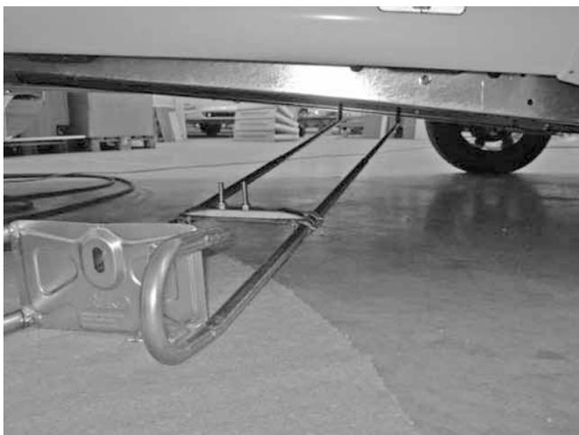
Bei den oben genannten Baureihen befindet sich das als Sonderwunsch verfügbare Reserverad an einem Halter unter dem Fahrzeug.
