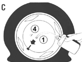
**C** Verschlussstopfen ④ von Einfüllschlauch ① abziehen. Einfüllschlauch auf Reifenventil aufschieben.
