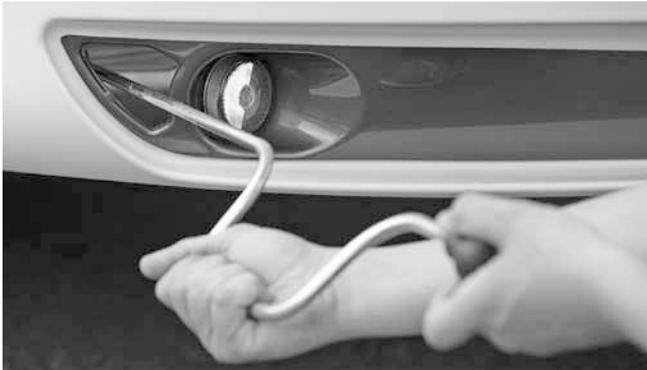
Die Ausdrehstützen befinden sich im hinteren und vorderen Bereich unter dem Caravan.
