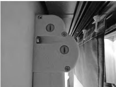
Rollos nicht über einen langen Zeitraum geschlossen lassen. Falls ein Rollo über die Zeit an Spannung verliert, können Sie mit einem Schlitzschraubendreher die Rollospannfeder nachspannen. Hierzu den Schraubendreher einstecken und ein bis zwei Umdrehungen im Uhrzeigersinn drehen.
