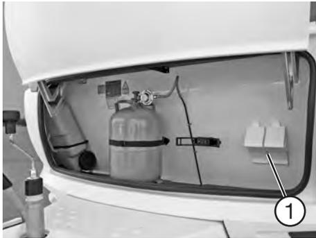
Unterlegkeile im Gasflaschenkasten
