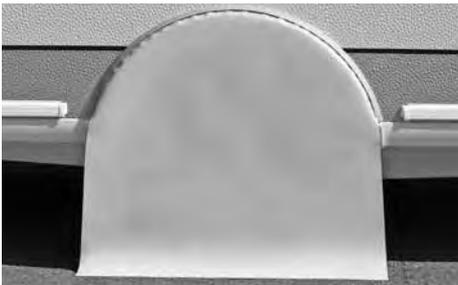
Radkastenblende mit integrierter Kederleiste für Radabdeckung
