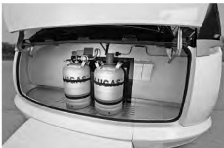
Positionierung der Gasflasche im Gasflaschenkasten
