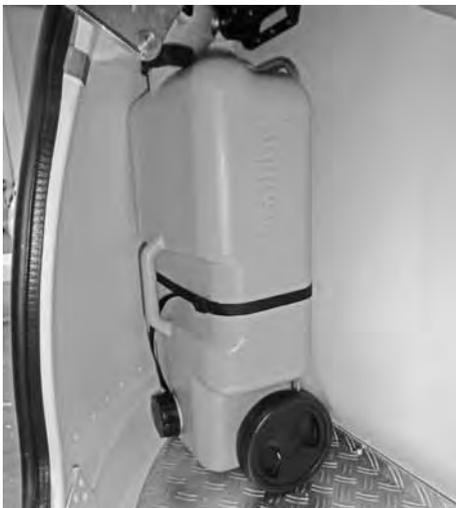
Abwassertank im Gasflaschenkasten
