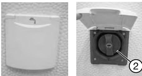
Einfüllstutzen für den Frischwassertank
