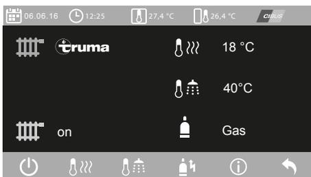
Dem Bediener werden auf den ersten Blick die gewünschte Raumtemperatur (°C), die kurzfristige Steigerung der Warmwassermenge zum Duschen (°C) (nicht bei VarioHeat) und die Betriebsart (Gas/Elektro\*) angezeigt. Das untere Menüsymbol wird grün angezeigt, wenn die Heizung in Betrieb ist.
