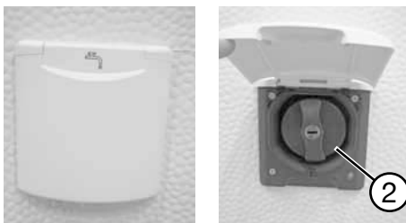
Einfüllstutzen für den Frischwassertank
