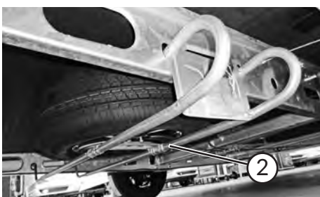
Reserveradhalter im Längsträger
