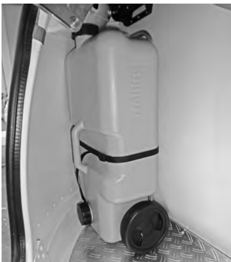
Abwassertank im Gasflaschenkasten
