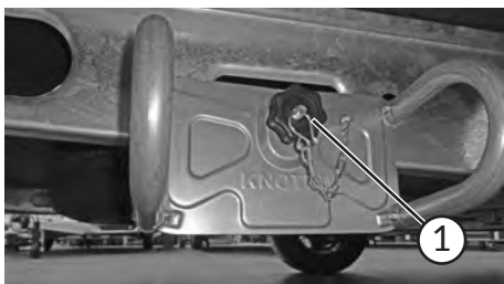
Schraubensicherung am Reserveradhalter
