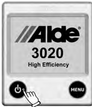
Bedienpanel der Warmwasserheizung
