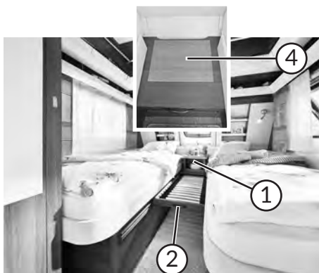
Umbau der Bettenverbreiterung
