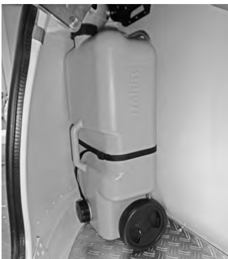
Abwassertank im Gasflaschenkasten
