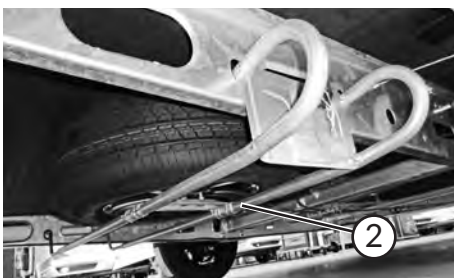
Reserveradhalter im Längsträger
