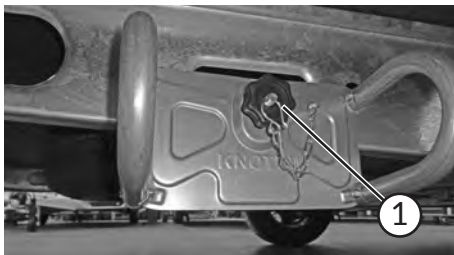
Schraubensicherung am Reserveradhalter
